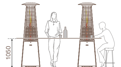
piano d'appoggio tra due apparecchi table top between two devices
