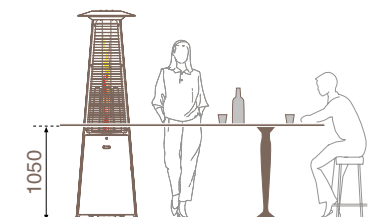
piano d'appoggio tra apparecchio e piede di sostegno (realizzato dall'utente) table top between the device and foot support (created by the user)
